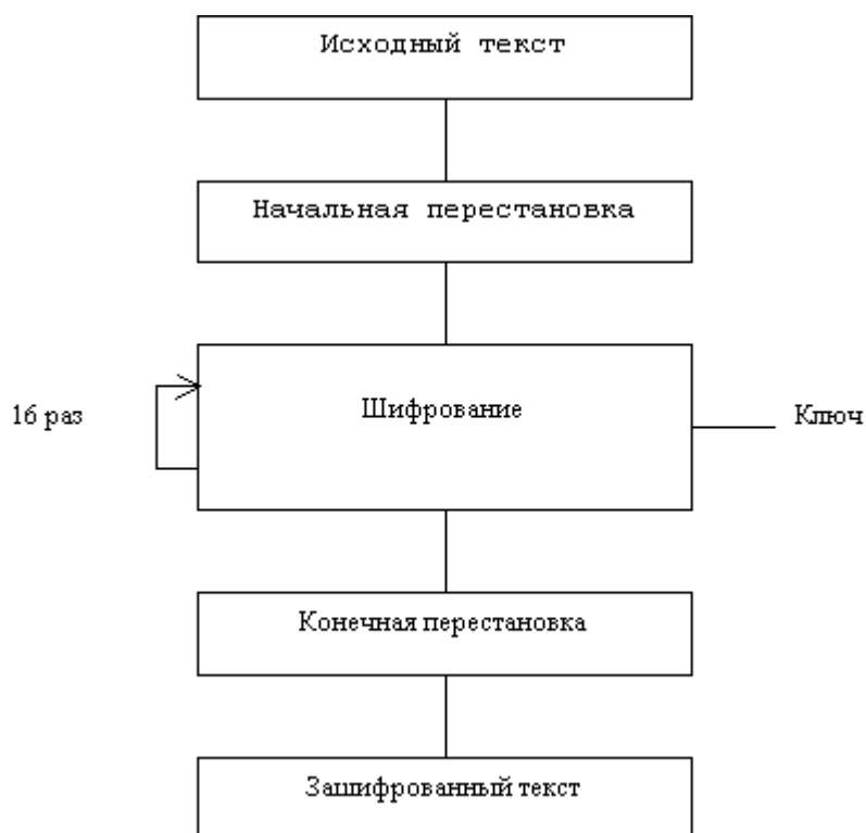
Рис.1. Обобщенная схема шифрования в алгоритме DES
