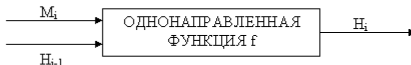
Рис.1. Построение однонаправленной хэш-функции
